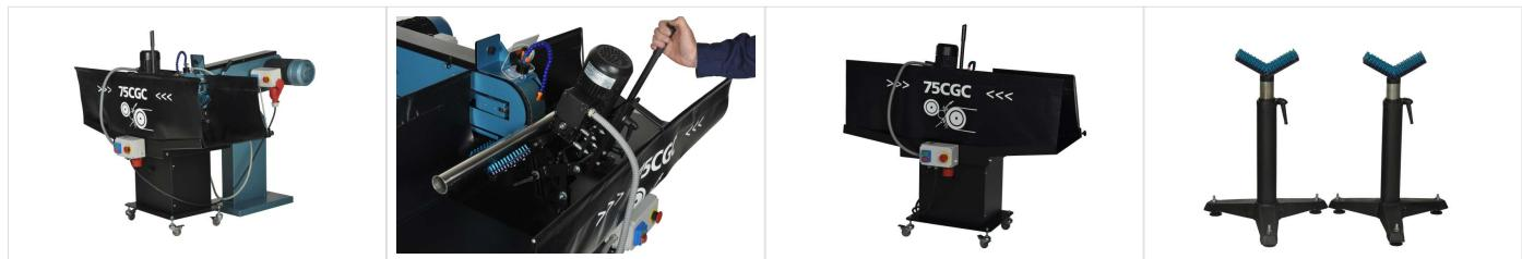
La rectifieuse et polisseuse sans centre ARBOGA 75 CGC est la rectifieuse/polisseuse parfaite pour les tuyaux en acier inoxydable avec son moteur à 2 vitesses et son système de refroidissement intégré.
