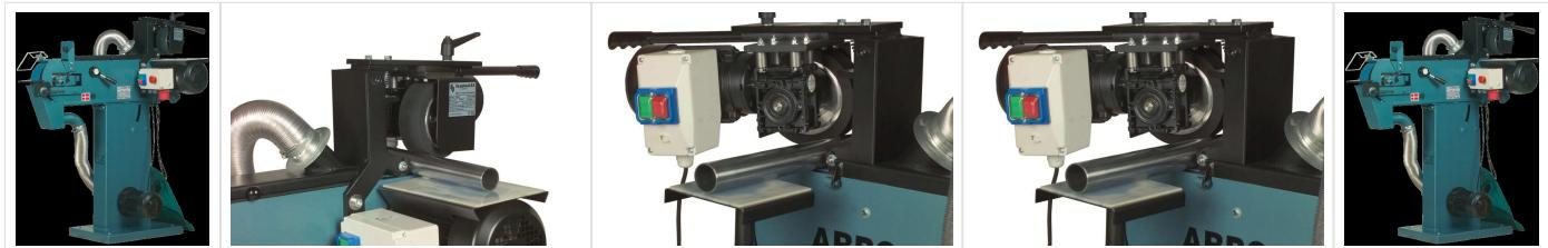
La rectifieuse-polisseuse centerless ARBOGA 75 CGX avec double système d'échappement intégré est fournie avec un accessoire qui peut être monté sur toutes les ponceuses à bande avec une bande de 75x2000 mm.
