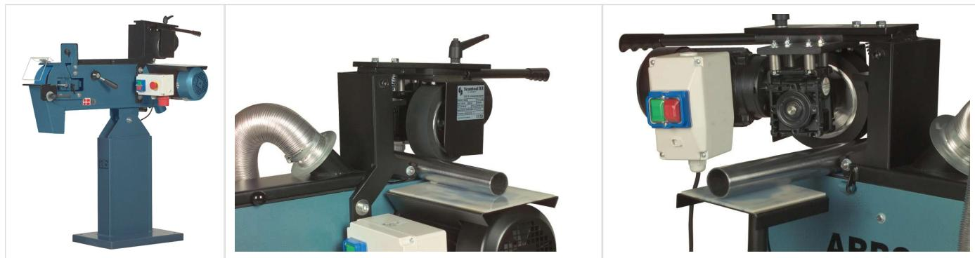
La rectifieuse-polisseuse centerless ARBOGA 75 CG est fournie avec un accessoire qui peut être monté sur toutes les ponceuses à bande avec une bande de 75x2000 mm et avec une grande surface de meulage sur le dessus.
