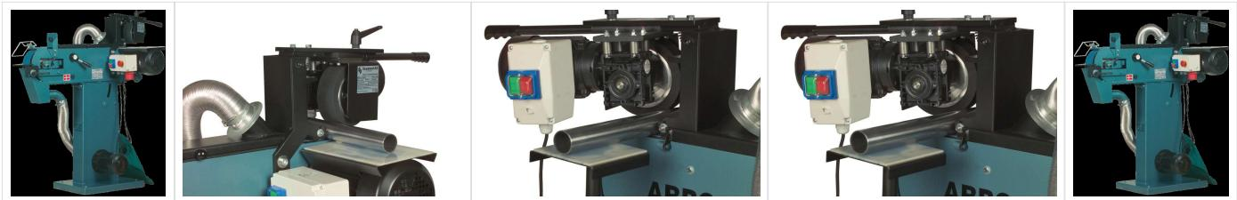
ARBOGA 75 CGX Centerless- Schleif- und Poliermaschinen zum Schleifen und Polieren von Rohroberflächen mit eingebauter Doppelabsaugung.
