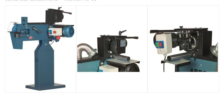
ARBOGA 75 CG Centerless- Schleif- und Poliermaschienen zum Schleifen und Polieren von Rohroberflächen. Die Centerless- Schleifmaschine ist leicht zu bedienen und kann Rohre mit einem Durchmesser von 10 - 120 mm schleifen und polieren.
